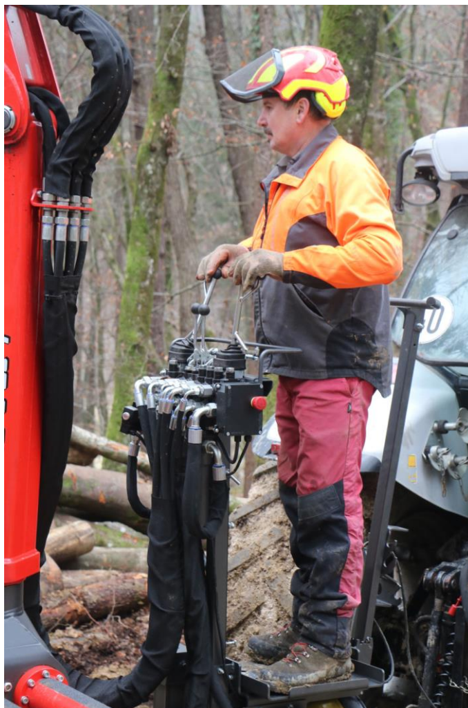
Slika 5: Gozdarsko dvigalo ima serijsko nameščeno proporcionalno mehansko krmiljenje, nameščeno na samem dvigalu, voznik pa ga krmili s stojišča nad vlečnim ojem. Kot dodatno opcijo pri krmiljenju dvigala ponujajo mehansko proporcionalno krmiljenje z električno vklopno/izklopno (on-off) funkcijo za teleskop in grabež (na sliki; rdeče stikalo na bloku krmilnih ventilov), proporcionalno nizkotlačno in krmiljenje s proporcionalnimi elektro krmilnimi ročicami.
