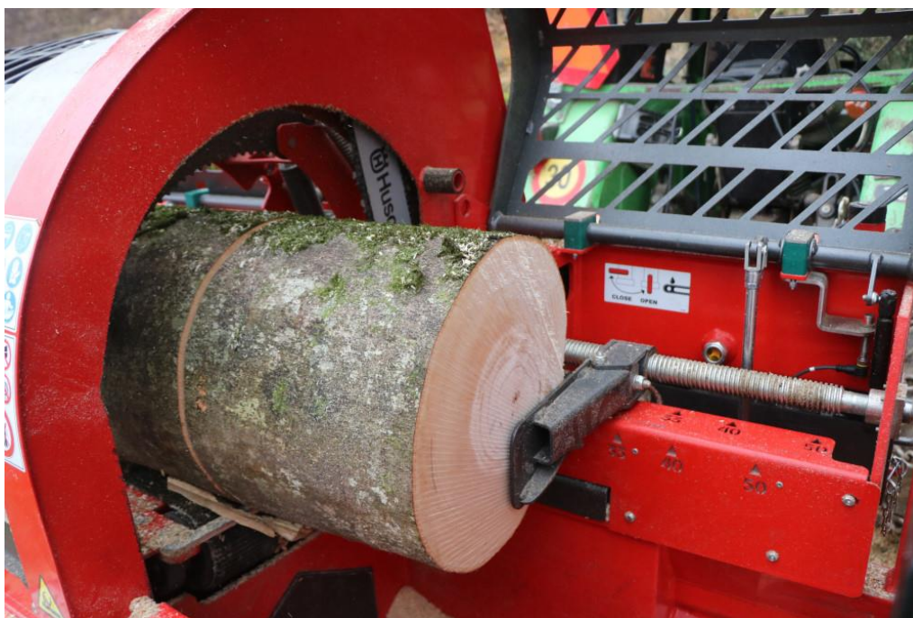
Slika 4: Dolžino polen nastavimo brezstopenjsko z omejevalom na navojnem vretenu in sicer od 20 do 50 cm. Pod desnim tečajem varovalnega pokrova je na kolenastem nosilniku nameščeno varnostno stikalo za izklop vseh funkcij stroja, ko dvignemo varovalni pokrov.
