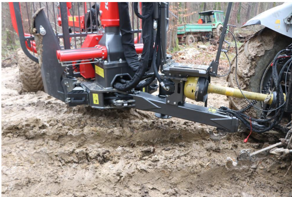
Slika 1: Zgibno vlečno oje, z zamikom levo in desno za 40 stopinj, je za delo v gozdu nepogrešljivo. Pri cestni vožnji ga je potrebno blokirati s sornikom. Nad ojem oz. pod stojiščem za delavca, ki krmili dvigalo je nameščena hidravlična črpalka dvigala, gnana s traktorsko priključno gredjo. Hidravlična valja zgibnega oja premikamo s hidravliko traktorja.
