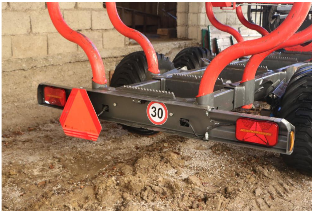
Slika 6: Za nakladalni prostor je opcijsko na voljo teleskopski podaljšek za prevoz daljšega lesa. Na njem je opcijsko tudi četrti par ročic. Na tem podaljšku so nameščene tudi LED luči in sicer na dveh preklopnih nosilcih, ki ju pri delu v gozdu preklopimo navznoter in tako zavarujemo luči pred poškodbami.
