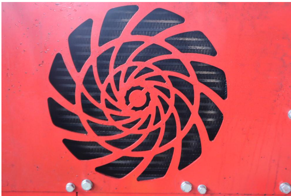
Slika 9: CS 420 pro ima standardno nameščen hladilnik hidravličnega olja, ki vzdržuje delovno temperaturo olja 65oC. V zalogovnik nalijemo 100 litrov olja.
