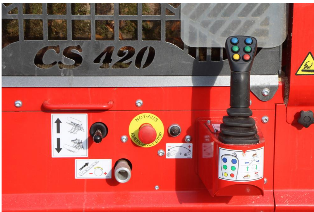
Slika 3: CS 420 pro je v celoti krmiljen elektrohidravlično. Osrednja je glavna krmilna ročica z dodatni krmilnimi tipkami oz. stikali. Z njo krmilimo dovajanje lesa, žaganje, cepljenje, položaj cepilnega noža, premik transportnega traku levo – desno, premik oporne lopute in zaustavitev/pomik nazaj cepilnega valja. Na krmilni plošči so še varnostno STOP stikalo, krmilna ročica dvizna mize/nakladalne rampe, vrtiljivo stikalo za tlak meča žaga ter vrtiljiv ventil za uravnavanje hitrosti transportnega traku.
