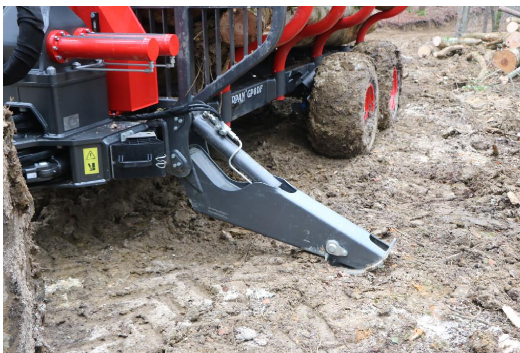
Slika 4: Gozdarska prikolica Krpan GP 8 DF ima serijsko nameščeno preklopno izvedbo stabilizatorjev (opornih nog) »flap down«, opcijsko pa je na voljo tudi teleskopska A izvedba.
