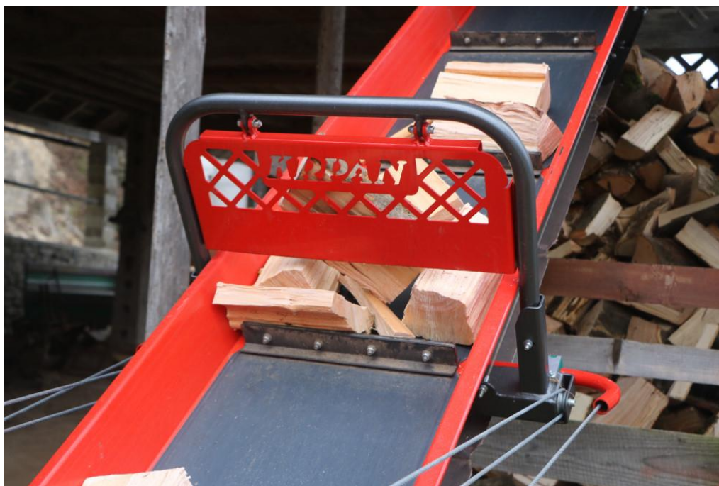
Slika 8: Krpanov rezalno cepilni stroj ima standardno nameščen 5 metrski transportni trak za polena. Hitrost premikanja traku je brezstopenjsko nastavljiva, premik levo – desno je prav tako hidravličen. Transportni trak ima na sredini nameščeno preklopno loputo, ki preprečuje kotaljenje polen proti rezalno cepilnemu stroju. Nagib traku uravnavamo s pomočjo ročnega vitla in jeklenih pletenic.
