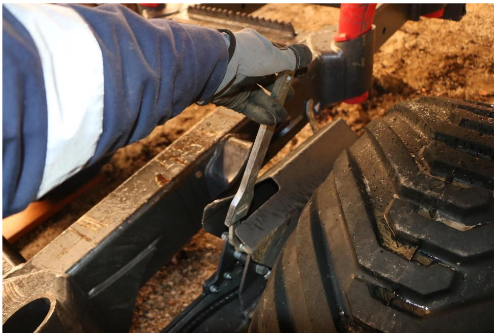
Slika 2: Vsa štiri kolesa tandem podvozja so serijsko opremljena s hidravličnimi zavorami. Pri parkiranju zavremo zadnji kolesi s premikom zavornega drogova s snemljivim vzvodom (na sliki). Opcijsko so na voljo zračne ali naletne zavore.
