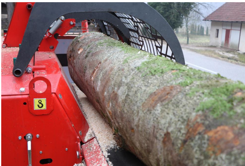
Slika 2: S CS 420 pro lahko razžagamo in razcepimo hlode premera do 42 cm. Poševna usmerjevalna pločevina (na sliki levo od hloda) olajša transport lesa v rezalni sklop.
