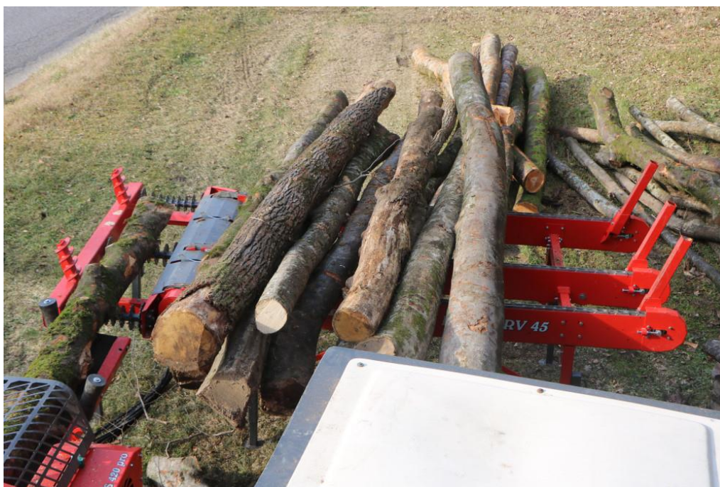
Slika 1: Za učinkovito delo z rezalno cepilnim strojem pri podjetju PIŠEK – Vitli KRPAN d.o.o. nudijo dve nakladalni rampi, ki imata nosilnost 4,2 tone in na kateri lahko naložimo do cca 6 m 3 hlodovine. Izvedba RV 45 je namenjena za stalno postavitev (na sliki), izvedba RV 45 M pa ima podvozje za prevoz. Uporaba rampe, ki na delovišču potrebuje prostor cca 4,5 x 9 m, omogoča, da s strojem učinkovito dela en delavec./h6>
