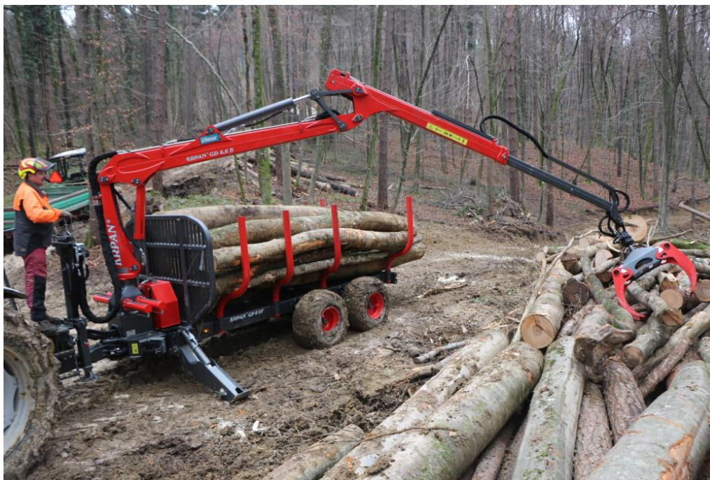
Slika 3: Na preskušano prikolico je bilo nameščeno gozdarsko dvigalo GD 6,6 K, ki ima enojno teleskopsko podaljšanje drugega dela dvizne roke in maksimalnim dosegom 6,6 m (zaprt grabež) oz. 7,2 m (odprt grabež).
