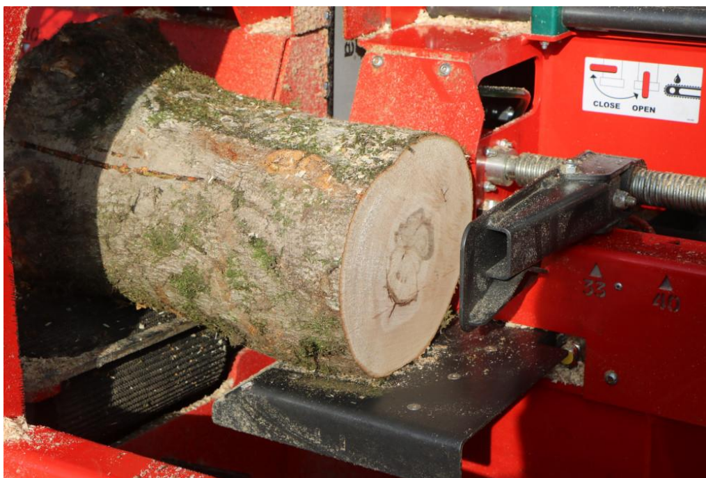
Slika 5: Za žaganje zadnjega kosa lesa je zelo koristna opora, ki jo po pritisku na stikalo iz ohišja potisne hidravlični valj. V začetni položaj se vrne samodejno po končanem žaganju ali pa po pritisku na stikalo.
