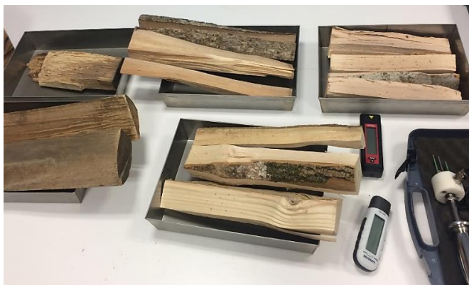
Slika 1: Drva /polena smo tik pred meritvijo razcepili na tri/štiri približno enake velike kose, ter meritve najprej opravili z elektro-uporovnimi merilniki na vsaj štirih različnih mestih. Takoj za tem smo vzorce stekali ter jih posušili, kot predpisuje metoda za gravimetrično določanje vlage.
