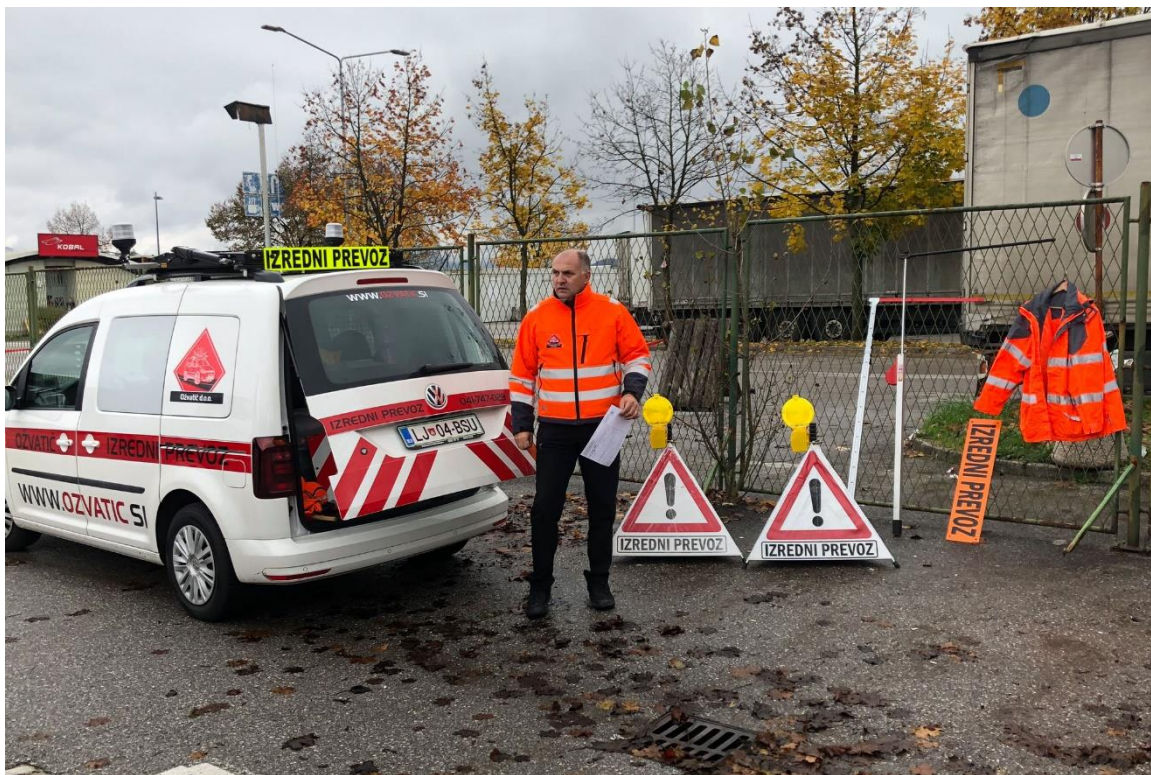
Slika: Praktično usposabljanje za spremljevalce izrednih prevozov pri pooblašeni organizaciji za usposabljanje B & B Izobraževanje in usposabljanje d.o.o. Na spremljevalnem vozilu je nameščena rumena odsevna označevalna tabla z napisom »izredni prevoz«, oranžna odsevna tabla z napisom »izredni prevoz«, ki se namesti na vozilo, ki izvaja izredni prevoz, pa je vidna ob ograji.
