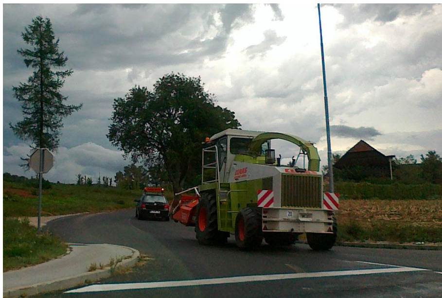
Slika: Izredni prevoz, ki se ne izvaja v skladu z dovoljenjem. Kombajn nima nameščene predpisane oranžne odsevne označevalne table z napisom »izredni prevoz«, spremljevalno vozilo pa ima označevalno tablo nepravilne barve, morala bi biti rumena. Oziroma tabla s spremljevalnega vozila bi morala biti nameščena na kombajnu. Na kombajnu so pravilno nameščene table za označevanje širokih vozil; te morajo biti nameščene vedno, kadar širina presega 2,55 m.
