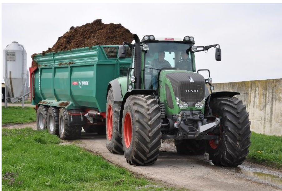
Slika: Največja skupna dovoljena masa traktorja znaša 18 ton, tridem priklopnika 24 ton, te skupine vozil (traktor + tridem priklopnik) pa 40 ton.
