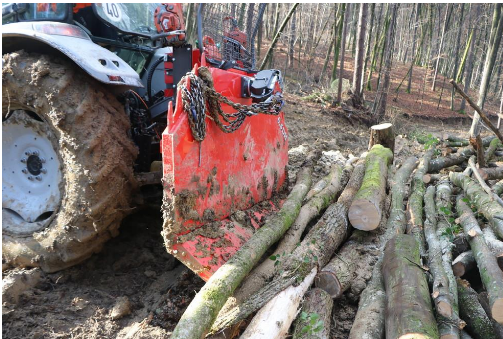
Slika 1: Opcijsko je na voljo hidravlično preklopljiv oz. gibljiv spodnji del deske vitla, kar pride zelo prav pri rampanju lesa.
