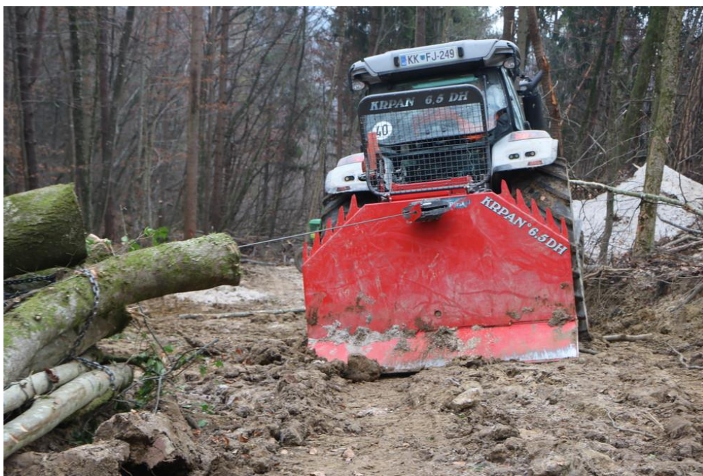
Slika 4: Vitel s konstantno vlečno silo 6,5 DH ima široko nosilno ploščo (naletno odzivno desko), na sliki je opsijska izvedba širine 2,2 m.
