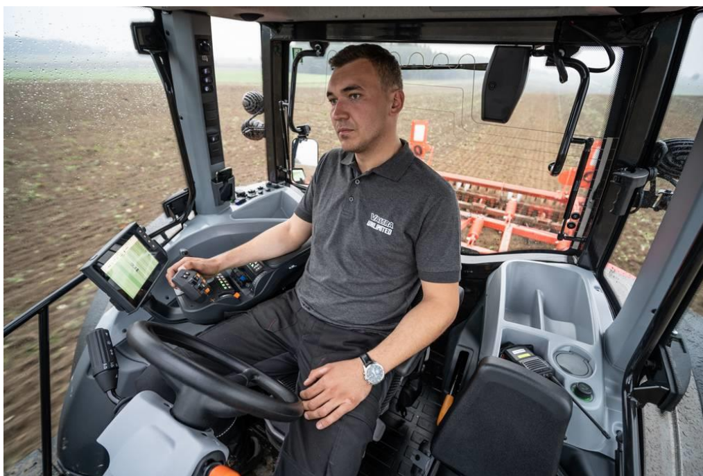
Slika 2 : Ogradje kabine serije G5 je zasnovano na enaki zasnovi kot pri seriji A, notranjost pa je prilagojena novi seriji, a kot je značilno za vse Valtra skandinavsko robustna in funkcionalna, npr. s številnimi odlagalnimi prostori. Na sliki izvedba krmiljenja funkcij traktorja Versu s krmilnimi napravami na naslonjalu za roko in krmilno nadzornim terminalom, kot pri serijah N, T in S.
